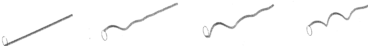
図1 先端が円運動をする場合のひもの運動の動的解析例 (先端については全時刻歴に渡る軌跡を予めプロットした)
