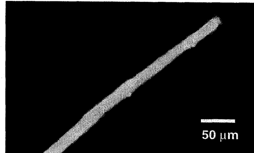
Figure. 10 蛍光顕微鏡によるポリジアセチレン/シリカファイバーの観察
