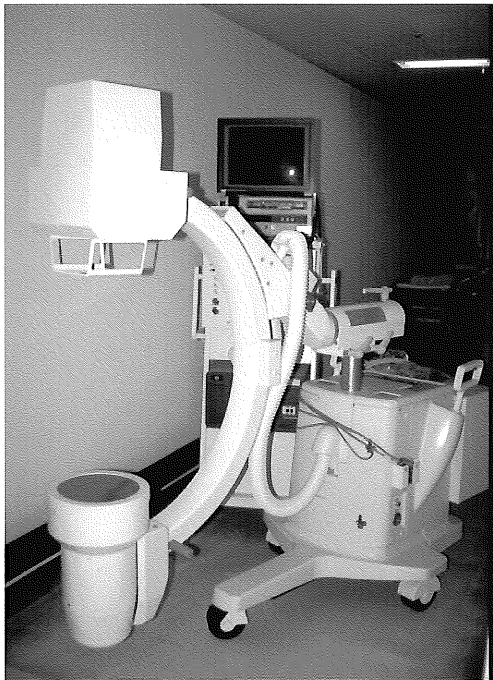
図-1 試作した可搬型ステレオ透視装置
