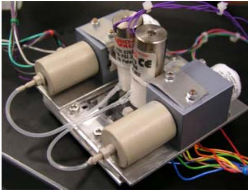
図3 Flow-through PCR 装置
