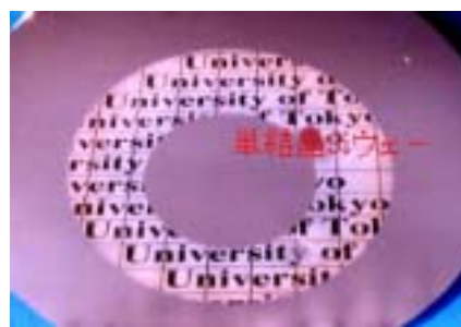
図3 粗面ウェーハの1パス切削面
