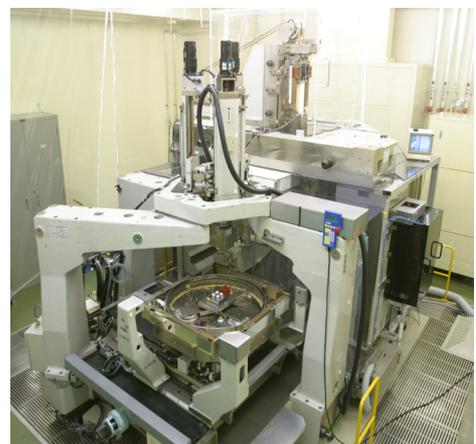
CSSP 自由曲面修正研磨，測定装置
