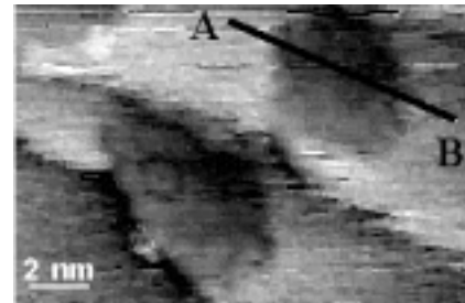
図6: K/N/Cu(100)の STM 像(形状像)。観察範囲は 10 \times 15 \text{ nm}^2 。
