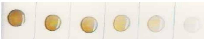
図5 0-10 mMシアン配糖体水溶液を滴下して15分後のテストプレートの写真
