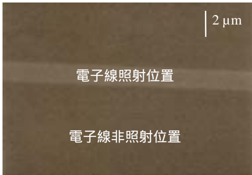
Fig. 1 作製したワイヤ構造 ( \text{Fe}(\text{CO})_5 600 L, 電子照射量 10 \mu\text{C}/\text{cm}^2 )
