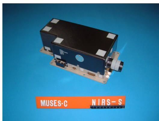
図1：はやぶさ探査機に搭載された近赤外線分光器
