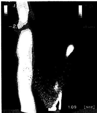
図 1 代表的な流れ場の様子（左：流れ方向速度、右：混合分率）
