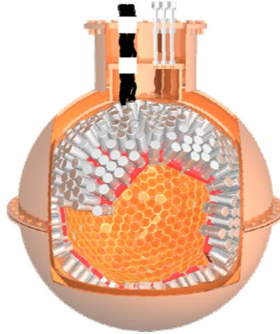
図 1. 800kg 液体キセノン検出器の概念図。検出器の直径は約 1 m で、約 800 本の低バックグラウンド光電子増倍管で液体キセノンを取り囲み測定を行う。
