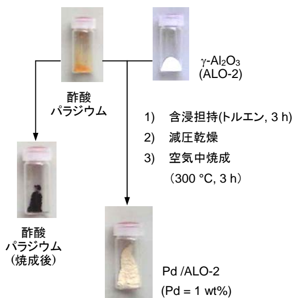
図 1. Pd / \gamma -Al 2 O 3 (ALO-2)の調製と外観
