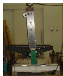
写1 傾斜付き引張試験
