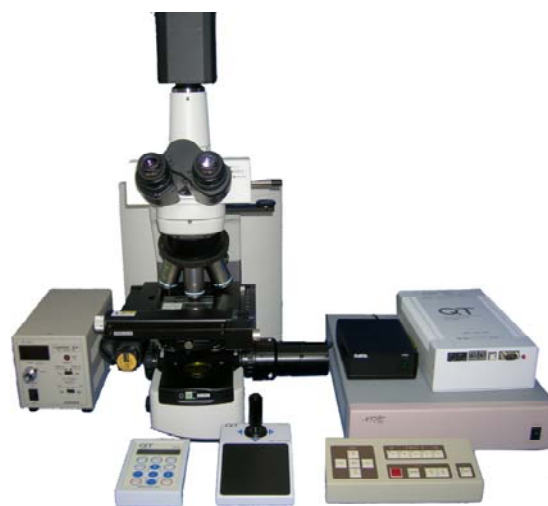
図3 自動標本観察システムの概観 (オートローダは除く)
