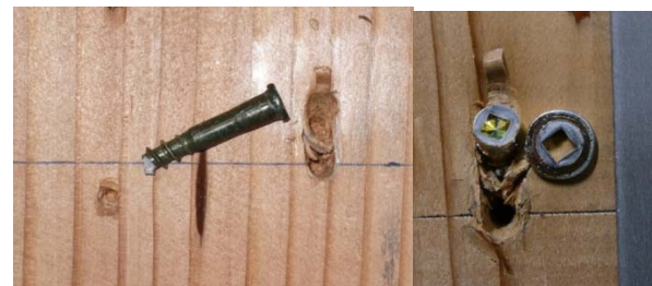
ねじ部の破断 頭とび
