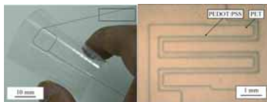
fig.11 製作したフレキシブルディスプレイ用タッチパネル
