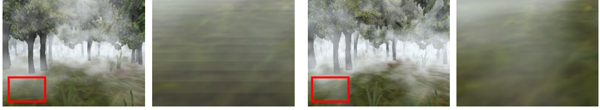
図 3: スライス法によるボリュームレンダリング(左)と、その拡大図(右)。エイリアシングが発生する。 図 4: 提案法によるボリュームレンダリング(左)と、その拡大図(右)。
