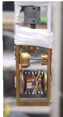
図 1 (a) 一軸回転型プローブ (b) カンチレバーを含むブリッジ回路
