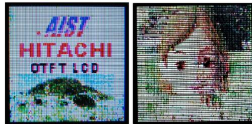
図6 有機TFT駆動カラー液晶試作ディスプレイ
