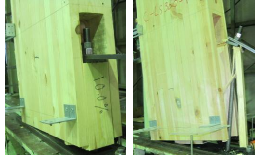
せん断破壊 (ブロック) せん断破壊 (ボルト曲げ)
