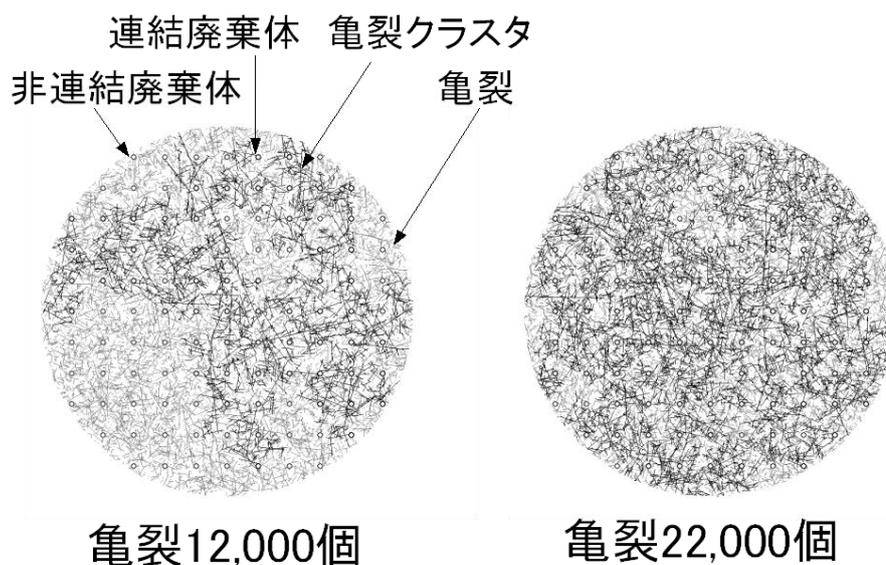
図 3 処分場モデルと亀裂クラスタ
